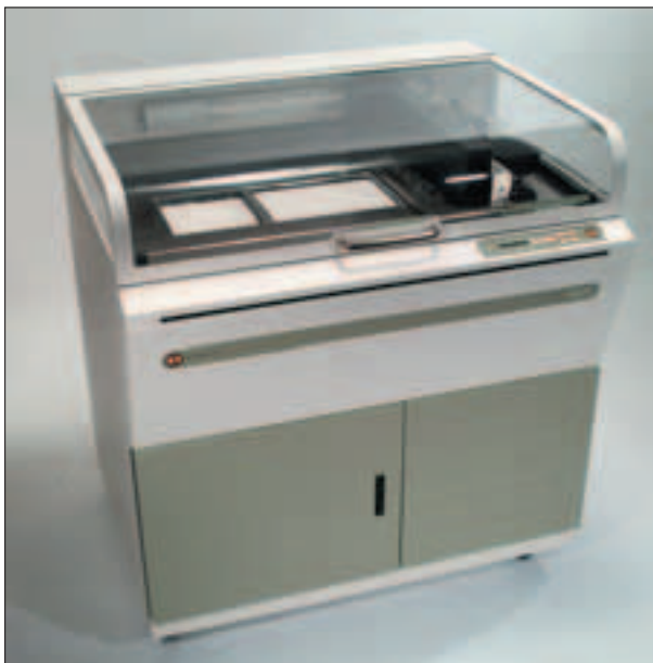
Современный трехмерный принтер ZPrinter 406 System. Скорость печати - от 2 слоев толщиной 0,076-0,254 мм в цвете до 6 слоев в монохроме в минуту. Поддержка форматов STL, VRML и PLY
